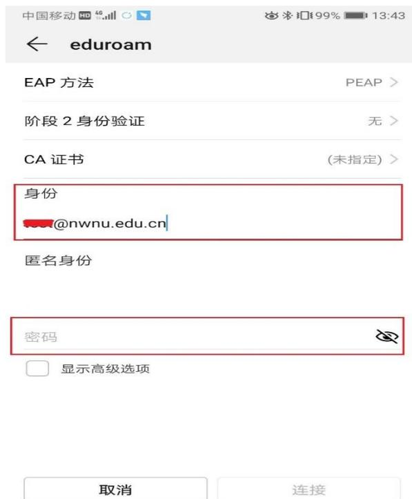
③输入密码后点击连接，显示连接成功，即可上网。
